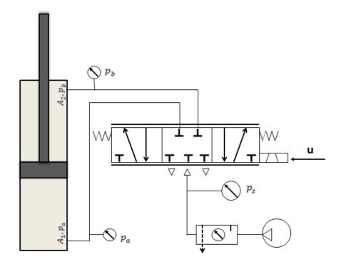
Figura 2: Desenho esquemático do circuito do Atuador Pneumático.
