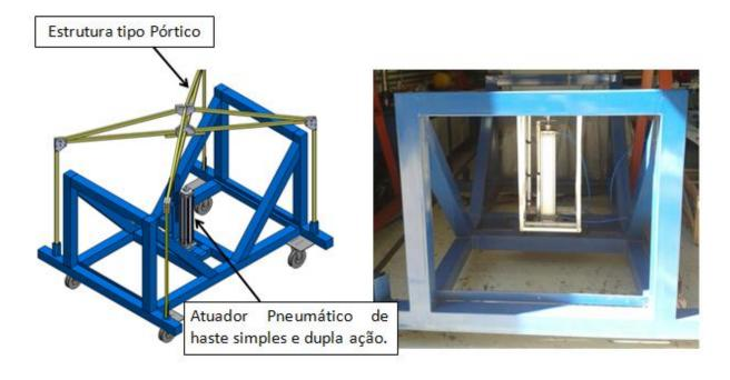
Figura 1: Vista isométrica (a) desenho, (b) fotografia do protótipo da bancada de ensaio de estruturas.
