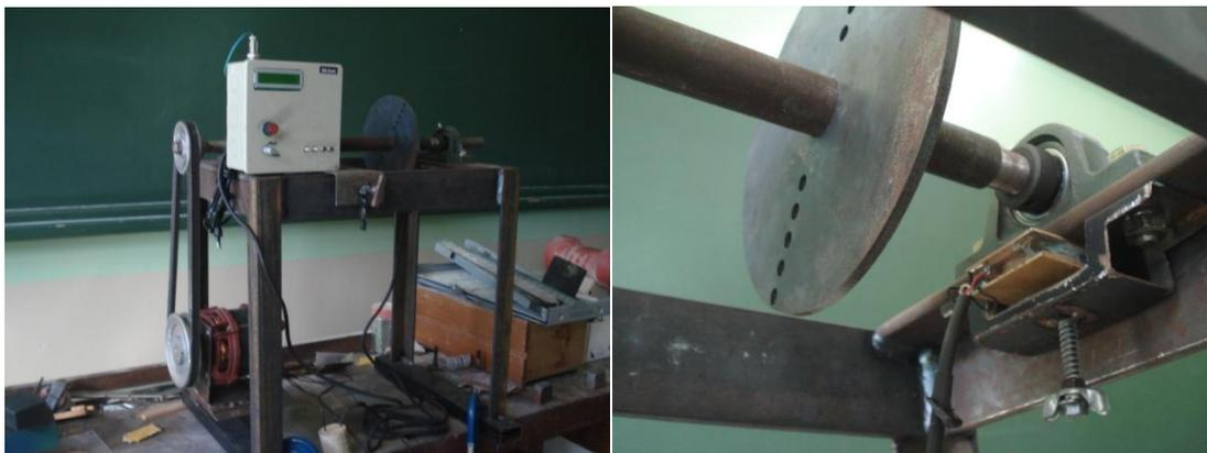
Figura 5. (a) Protótipo experimental do balanceador de eixos e detalhes de instalação do sensor piezoelétrico.
