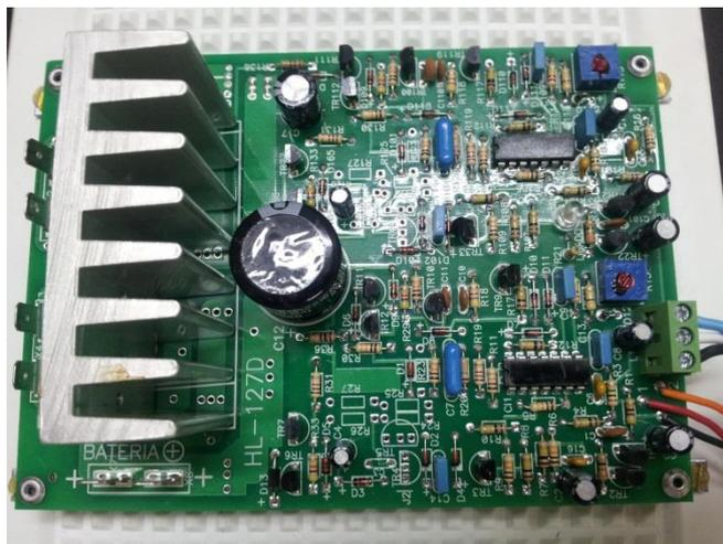
**Figura 9. Placa de controle dos motores por PWM.**
