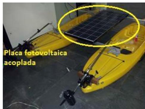
**Figura 18. Estrutura montada.**
