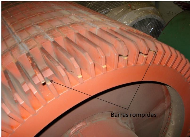
Figura 3. Rotor tipo gaiola de esquilo com barras rompidas.
