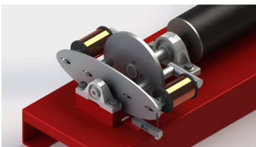
Figura 3. Detalhe da célula de carga e do sistema de freio
