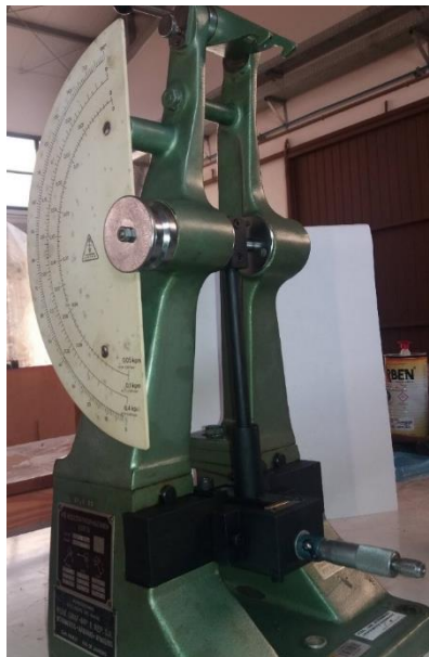
Figura 01 – Esclerômetro Pendular
