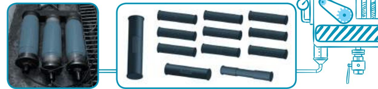
Figura 3 > Corpos de prova hidrostáticos com danos artificiais reparados com luvas de compósito.
