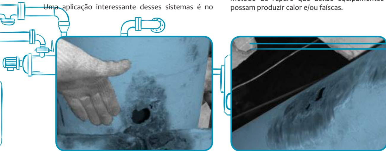
Figura 7 > Danos de corrosão em tubulações de água descartada.
