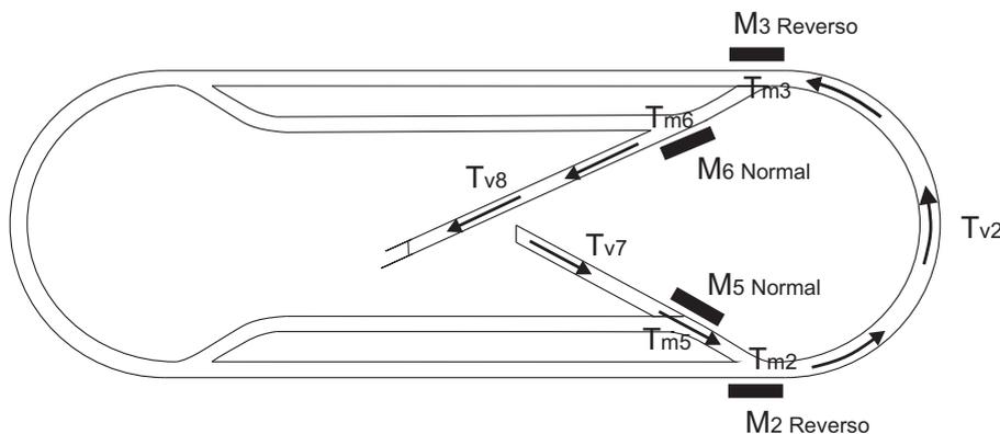
Figure 4. Esquemático segundo o deslocamento da locomotiva do  $Tv_7$  para o  $Tv_8$
