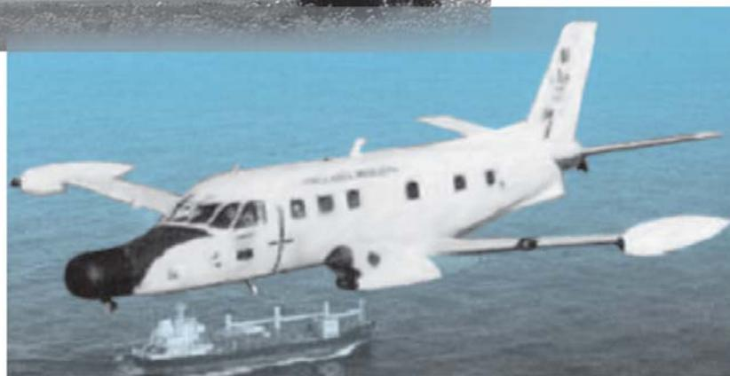
Fig. 7 A variante P-95B do EMB-111 incorpora o diedro na empennagem horizontal para reduzir os efeitos da esteira da asa (downwash). Foto, Embraer
