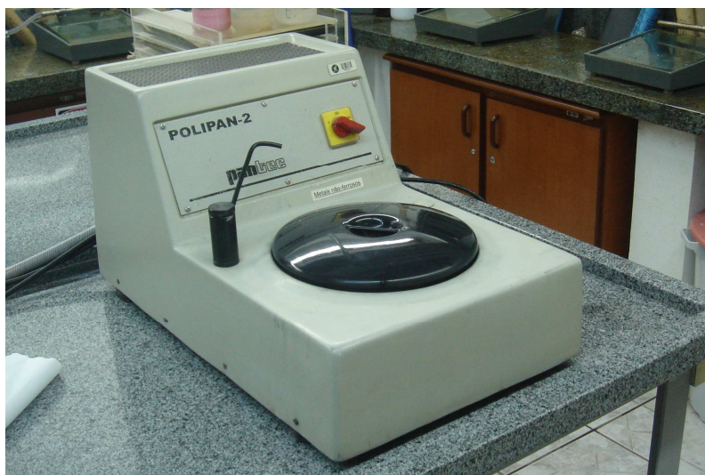
Figura 53 - Politriz PANTEC utilizada para o polimento das amostras. Fonte: Autor
