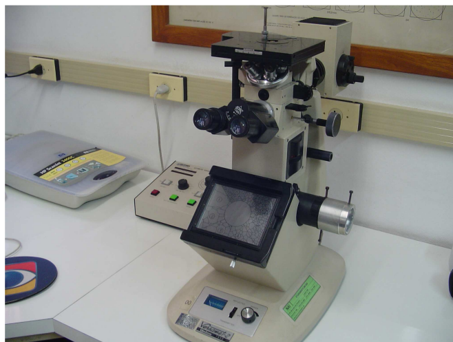
Figura 54 - Microscópio Union Versamet II utilizado na captura de imagens das amostras. Fonte: Autor
