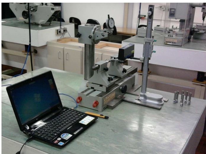
Figura 60 - Sistema montado para medir rugosidades. Fonte: Autor
