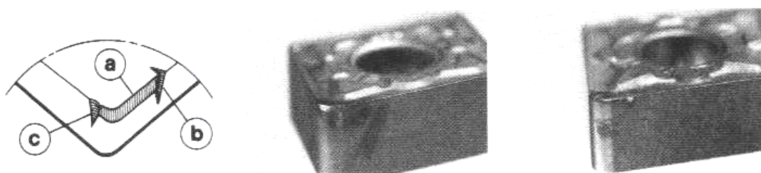
Figura 13 - Desgaste frontal ou de flanco. Fonte: Diniz, 2000 et al.
