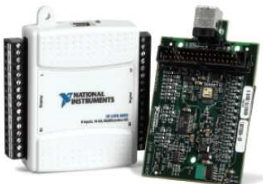
Figura 39 - Placa de aquisição de dados NI6009. Fonte: National Instruments®, 2011
