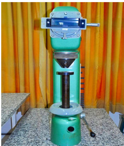
Figura 52 - Durômetro Brinell/Vickers utilizado no ensaio. Fonte: Autor
