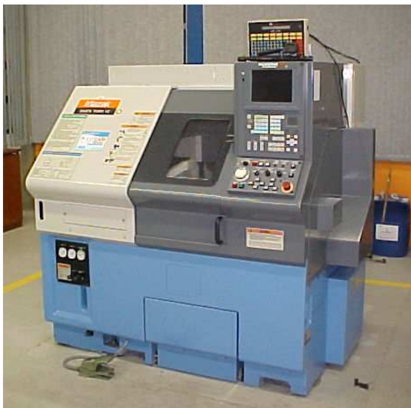
Figura 31 - Torno MAZAK QT10 usado para os ensaios. Fonte: Autor
