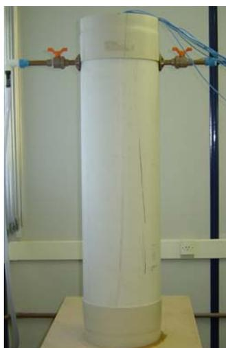
Figura 2. Tanque Armazenador de PVC.
