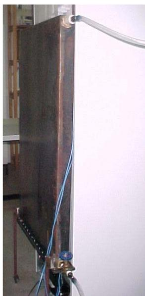
Figura 4. Tanque de Aço Revestindo o Condensador.
