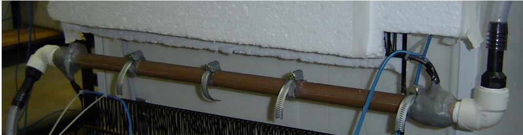
Figura 5. Vista em Detalhe do Trocador de Calor Casco Tubo.
