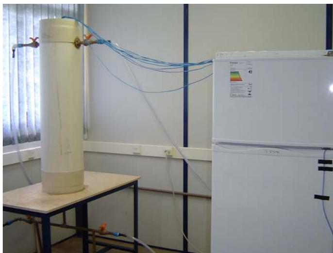
Figura 1. Refrigerador e Tanque Armazenador.
