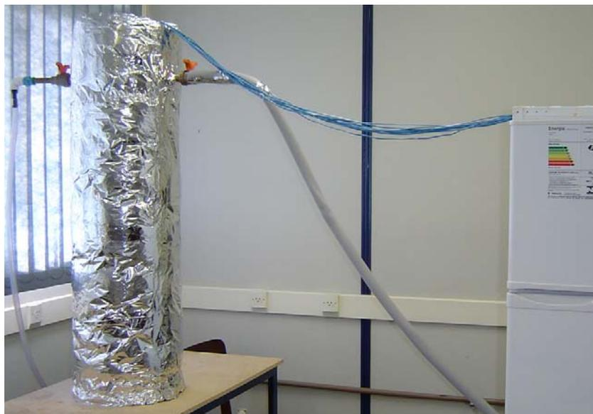
Figura 6. Tanque e tubulação isolada.
