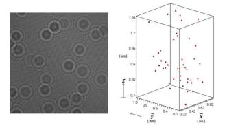
Figura 1. Holograma original e o volume de partículas reconstruído
