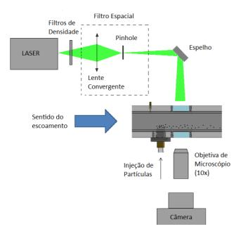
**Figura** 2. Montagem ótica para a captura de hologramas
