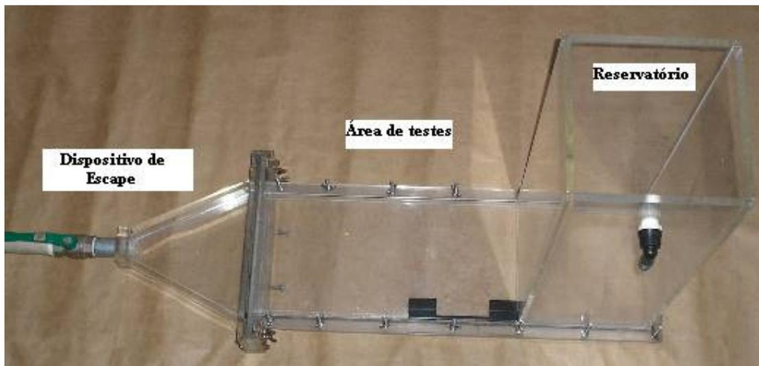
Figura 2: Célula de Hele Shaw utilizada nos testes
