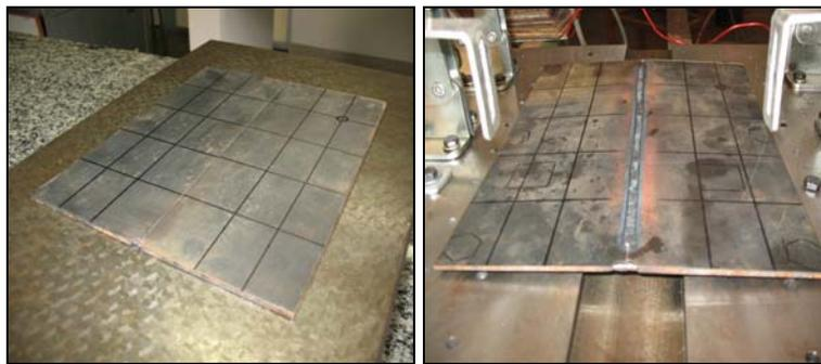
Figura1: Antes (chapa plana) e após a soldagem (chapa com distorções)
