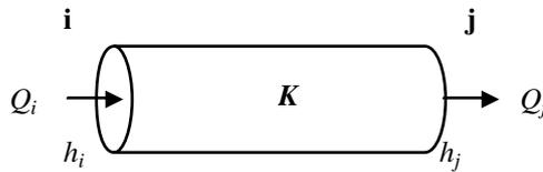
Figura 2: Tubo entre os nós  $i$  e  $j$  com constante  $K$ , vazões  $Q$  e pressões  $h$ .
