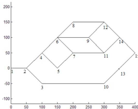
Figura 4: Esquema geométrico de uma rede de tubulações.
