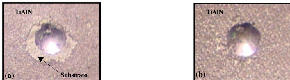
Figura 2 - Indentações Rockwell C realizadas nos insertos revestidos de TiAlN: (a) - TiAlN e (b) - TiAlN-laser. (Microscopia óptica, 50X)
