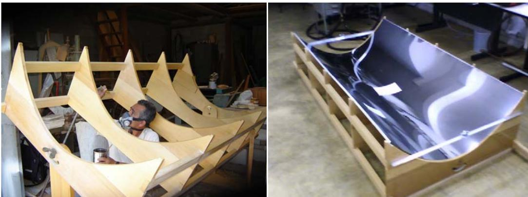
Figura 4: (a) Estrutura parabólica em madeira em construção, (b) Superfície reflexiva instalada na estrutura de madeira
