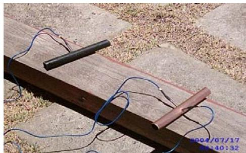
Figura 7: Experimento para seleção do acabamento superficial do tubo coletor focal.
