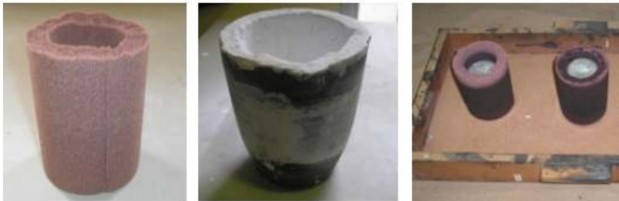
Figura 1: a) Molde em processo de cura; b)- Cadinho; c) Molde com a liga Al-7%Si
