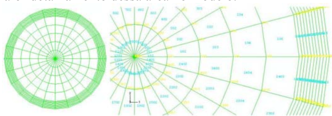
Figura 1. Representação da malha utilizada nas simulações
