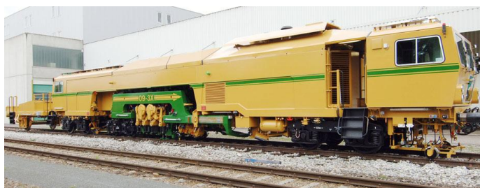
Figura 6. Socadora de via permanente modelo 09-3X Fonte: Manual de Operação Plasser & Theurer
