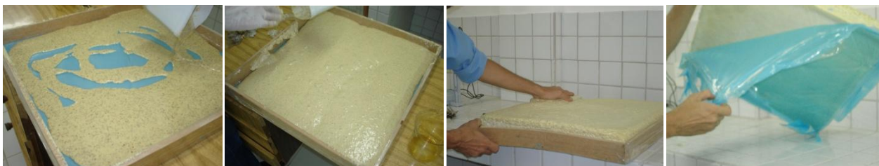
Figura 1. Etapas da confecção das placas. Mistura; moldagem, cura e desmolde
