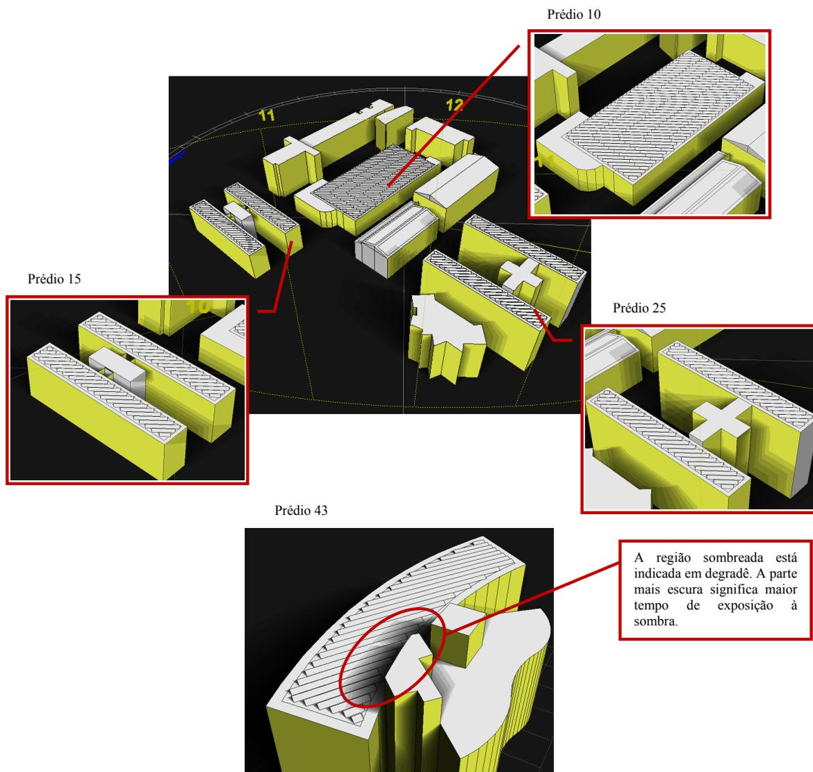
**Figura 3. Imagem da simulação de sombreamento sobre os módulos instalados nas coberturas dos prédios no período de 9:00 às 15:00h, do dia 21 de junho**
