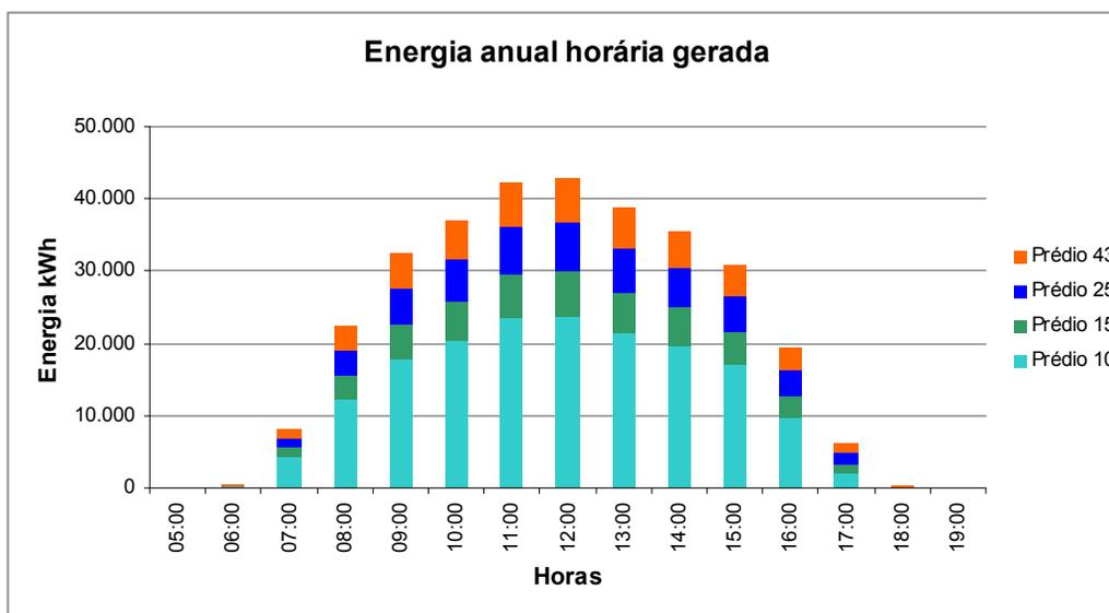
**Figura 5. Energia anual gerada (kWh) - por prédio - módulo Kyocera KD180GX-LP**
