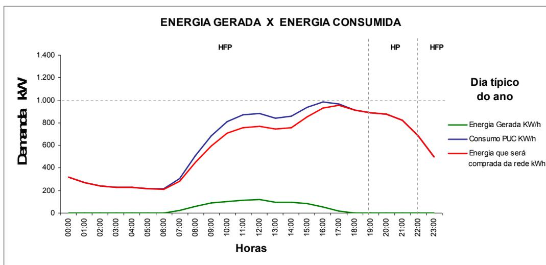
**Figura 6. Energia gerada pelos sistemas fotovoltaicos com módulo Kyocera KD180GX-LP e energia consumida pela PUCMinas Coração Eucarístico**
