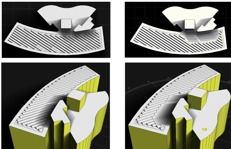
**Figura 4. Imagem da simulação de sombreamento sobre os módulos instalados na cobertura do Prédio 43 no período de 9:00 às 15:00h, do dia 21 de junho, com e sem os módulos instalados na região de sombreamento**
