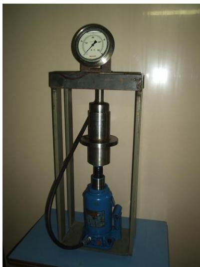
**Figura 6. Prensa com a sua estrutura totalmente montada e já com a adaptação do manômetro.**
