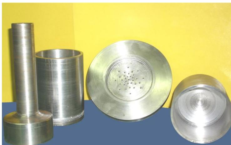
**Figura 4. Prensa para extração de óleo das oleaginosas, projetada e construída no Laboratório de Mecânica e Materiais do IFMA para desenvolvimento de pesquisa. Fonte: Mafra, 2008.**
