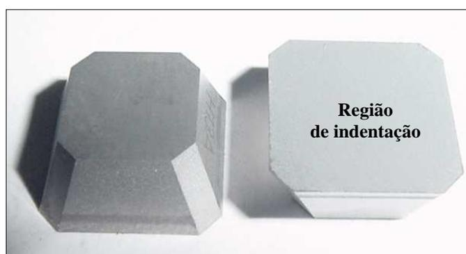
Figura 2. Região de indentação na superfície de saída dos insertos.
