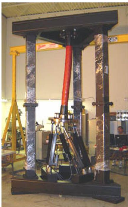
**Figura 3. Bancada para ensaios dinâmicos em tubos flexíveis (Deepflex, Universal Pipe Tester).**
