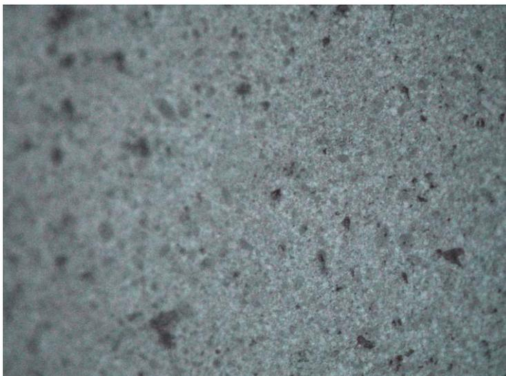
Figura 2, Microscopia óptica da cerâmica  $\text{Ca}_2\text{AlZrO}_{5,5}$  (magnificação 200X)
