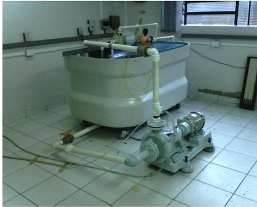
Figura 8 - Bancada de testes utilizada para simulação de falhas.
