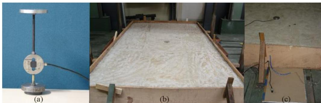
Figura 5. (a) célula de carga com base magnética para fixação no piso da laje de reação, (b) base com a cavidade de abrigo (poço) da célula de carga, (c) célula de carga posicionada dentro da cavidade.
