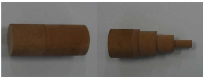
**Figura 1. Tarugo e peça final do experimento**
