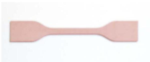
**Figura 5. Corpo de prova para ensaio de tração**
