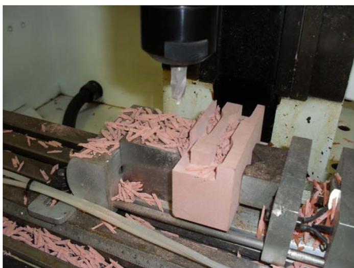
**Figura 6. Usinagem do corpo de prova**
