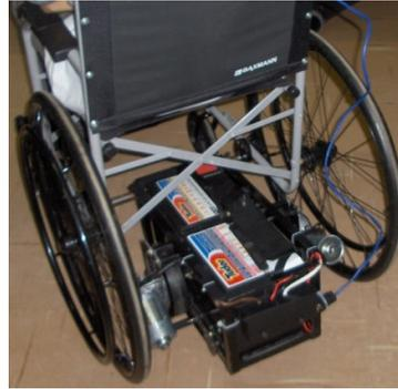
Figura 1. Kit de motorização para cadeiras de rodas manuais
