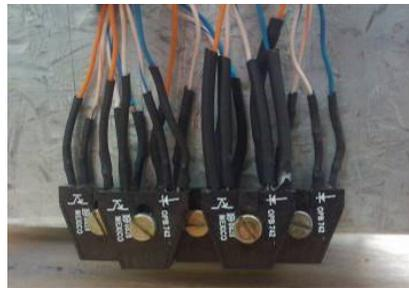
Figura 9. Sensor Fotoelétrico (Datasheet OPB742 ,2010)
