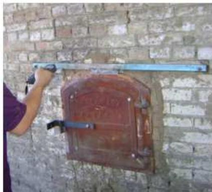
Figura 3. Medição da emissividade da parede.
