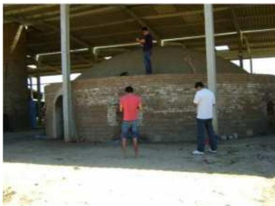
Figura 2. Forno abóbada
