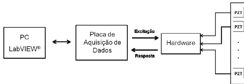
Figura 4 - Arquitetura básica do sistema baseado em Hardware.
