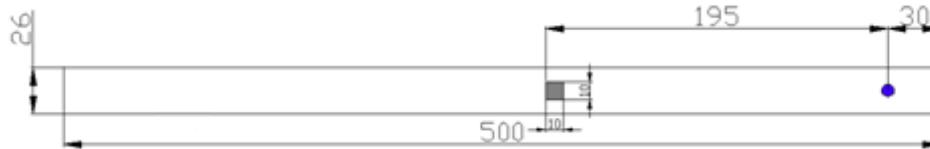
Figura 10 - Dimensões da viga e posições do PZT e do rebite
