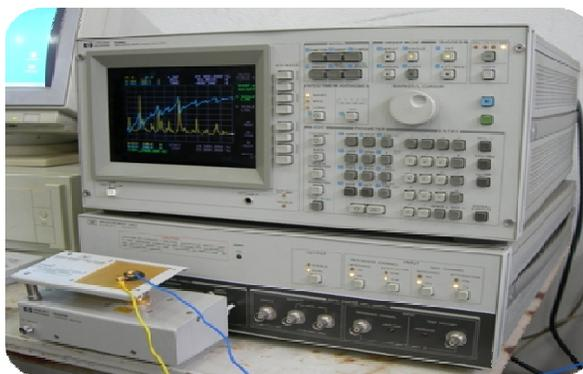
Figura 2 - Analisador de impedância (HP4194A)
