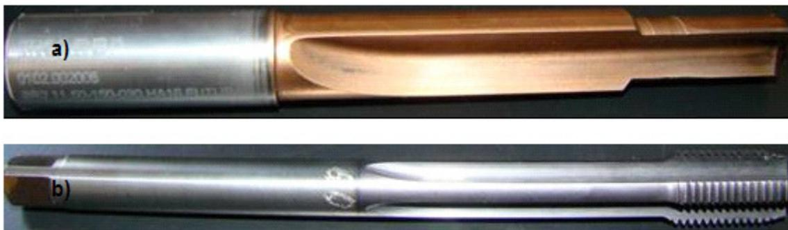
Figura 2. Ferramentas utilizadas nos ensaios de rosqueamento de ferro fundido vermicular; a) broca escalonada; b) macho de corte M13 X 1,5mm.
