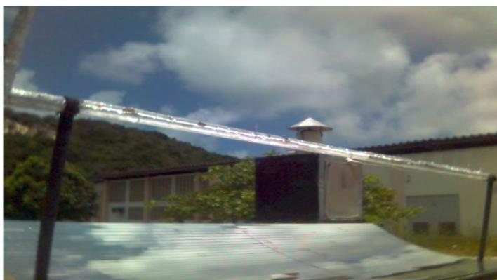
Figura 3. Tubo absorvedor do concentrador proposto
