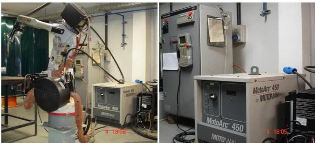
Figura 1. Robô utilizado para automatização da soldagem GMAW
