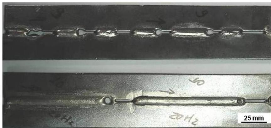
**Figura 8. Solda entre chapas. Na chapa superior, não foi aplicada oscilação magnética e houve a ocorrência de grande instabilidade da poça de fusão e vários furos. Na chapa inferior, sob a ação da oscilação magnética, foi notada notoriamente maior estabilidade na poça de fusão.**
