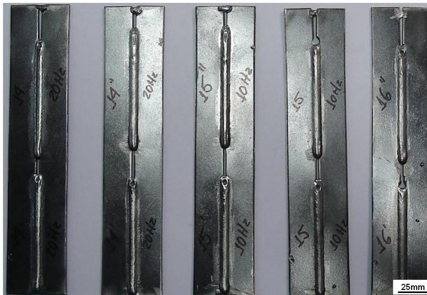
**Figura 4. Cordões de solda depositados entre chapas com espessura de 2 mm**
