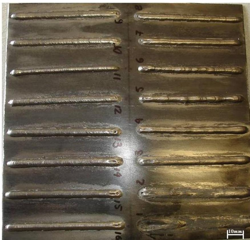
**Figura 3. Cordões de solda sobre chapa de 2 mm**
