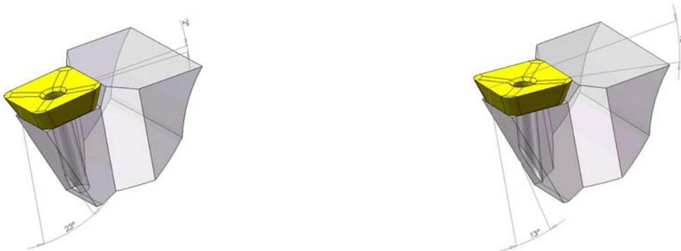
Figure 2. (a) Tool geometry G1 ( $\gamma_o = +2^\circ$ ;  $\alpha_o = 23^\circ$ ;  $\lambda_s = 0^\circ$ ;  $\chi_r = 45^\circ$ ;  $\epsilon_r = 90^\circ$ ;  $r = 2\text{mm}$ ); (b) Tool geometry G2 ( $\gamma_o = +12^\circ$ ;  $\alpha_o = 13^\circ$ ;  $\lambda_s = 0^\circ$ ;  $\chi_r = 45^\circ$ ;  $\epsilon_r = 90^\circ$ ;  $r = 2\text{mm}$ ).
