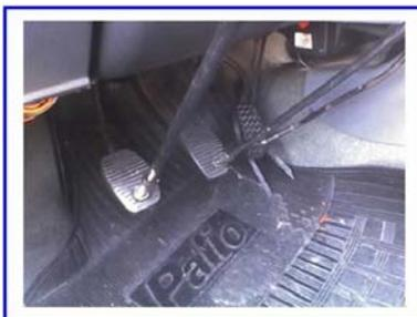
Figura 4 – Acionador de pedais com alavanca manual adaptados para deficientes físicos.
