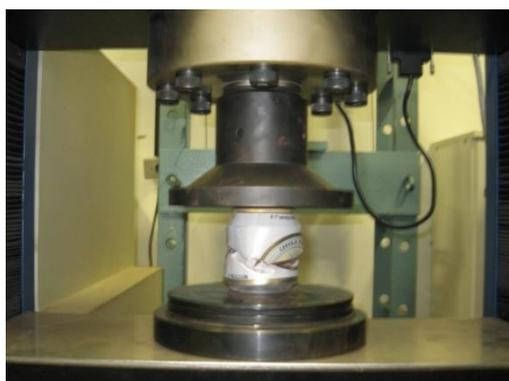
Figura 6. Foto do ensaio de compressão em uma lata de alumínio
