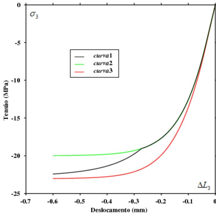
Figura 5. Curva tensão deslocamento para o estado de tensão em compressão
