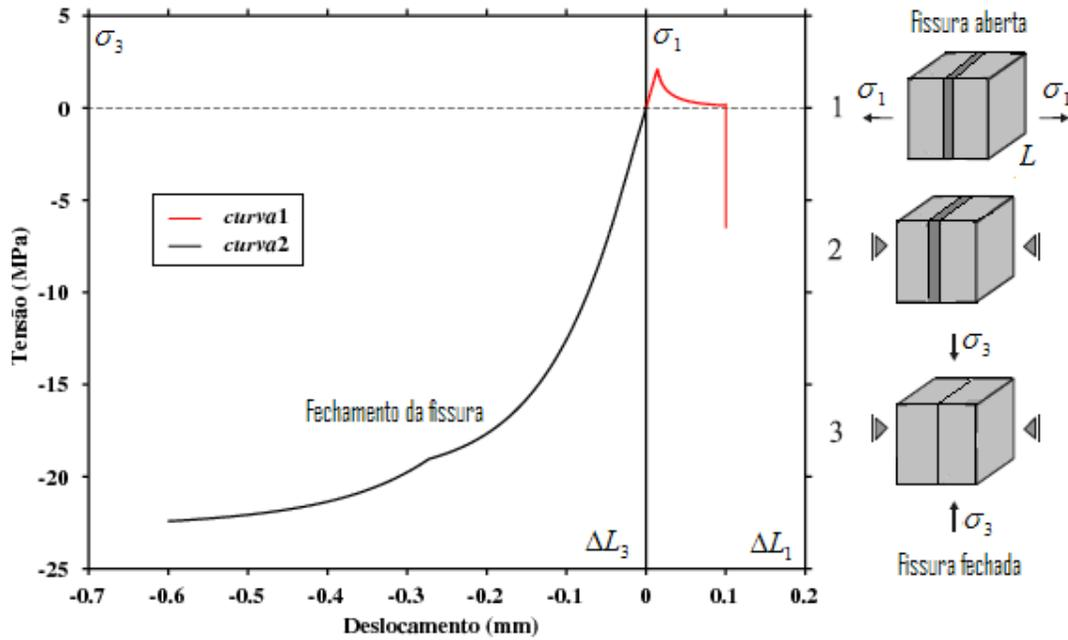
Figura 4. Curva tensão versus deslocamento com fissura localizada para o estado de tensão biaxial
