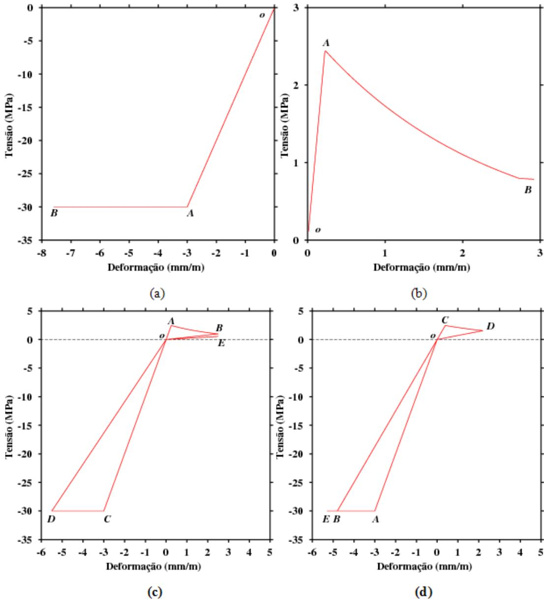
Figura 2. Curva tensão versus deformação: (a) compressão, (b) tração, (C) tração compressão e (d) compressão tração
