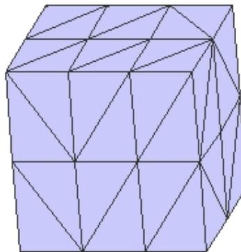
**Figura 3. Cubo com malha de elementos finitos tetraédricos**
