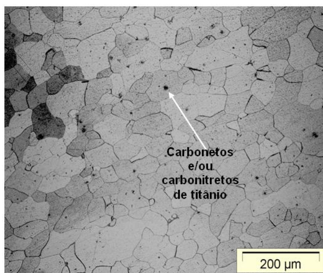
Figura 3. Microestrutura do metal base (AISI 444) – Microscopia Óptica. Ataque: Água Régia.
