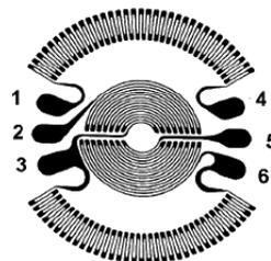
Figura 8. Extensômetros utilizados em diafragmas Doebelin (1990).
