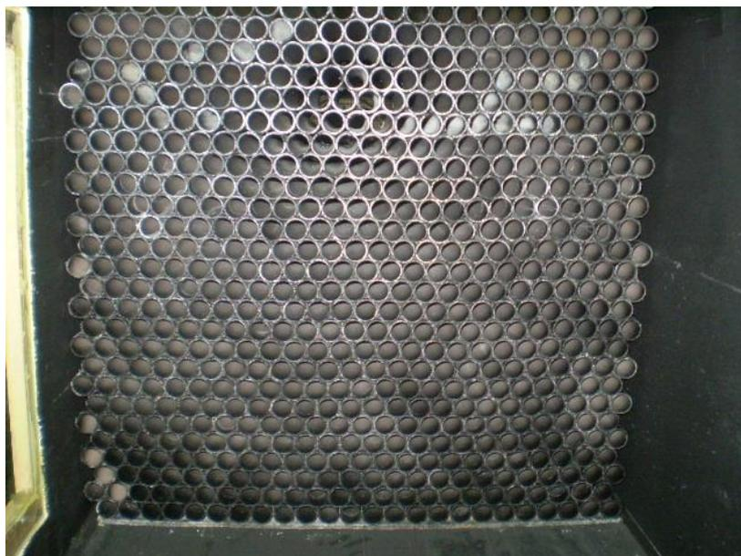
Figura 7. Caixa de uniformização do tipo colméia.
