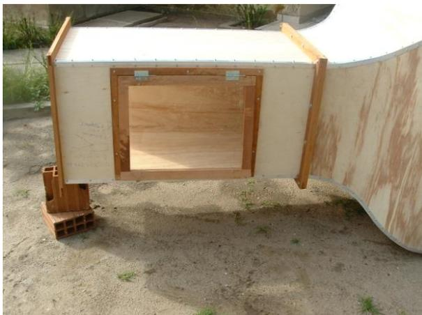
Figura 5. Construção da seção de ensaios.
