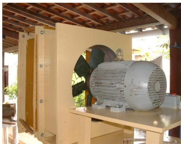
Figura 6. Ventilador Centrífugo.
