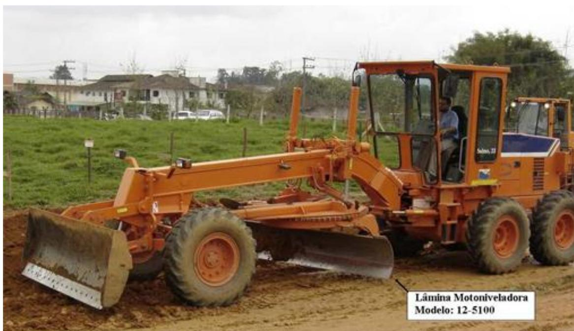
Figura 1 – Lâmina em trator motonivelador.
