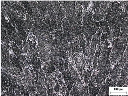
**Figura 2. Visualização da microestrutura do metal de solda.**
