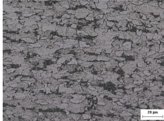
**Figura 3. Visualização da microestrutura do metal de base.**
