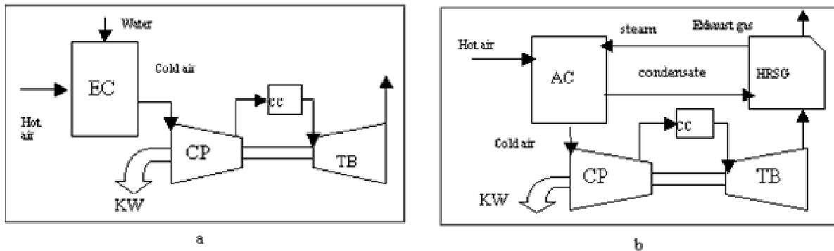
Figure 5 – a) GTEC scheme. b) GTAC scheme
