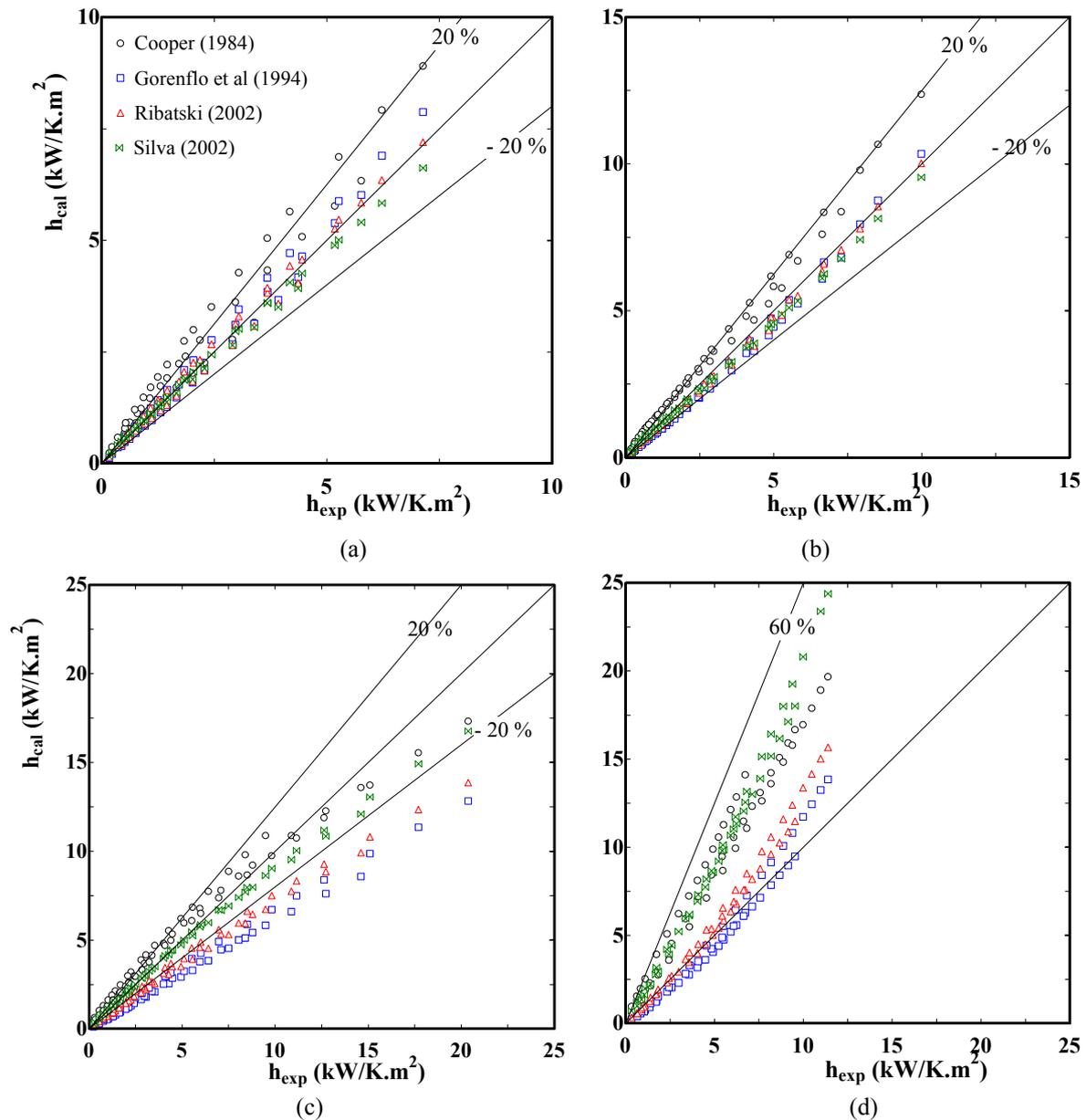
**Figure 5.** Calculated versus experimental heat transfer coefficient. (a)  $Ra=0.17 \mu\text{m}$ ; (b)  $0.45 \mu\text{m}$ ; (c)  $2.3 \mu\text{m}$ ; (d)  $4.6 \mu\text{m}$ .
