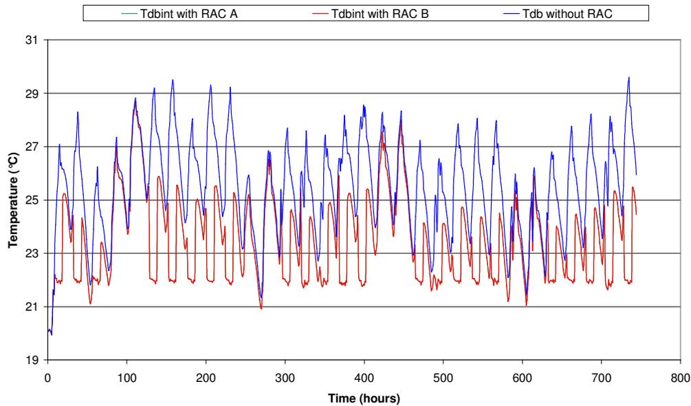
Figure 10: Room air temperature from Jan. 1<sup>st</sup> to Jan. 31<sup>st</sup>.
