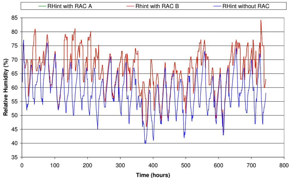
Figure 11: Room air relative humidity from Jan. 1<sup>st</sup> to Jan. 31<sup>st</sup>.
