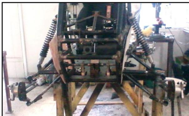
**Figura 9. Suspensão dianteira do protótipo VR BAJA 2012.**
