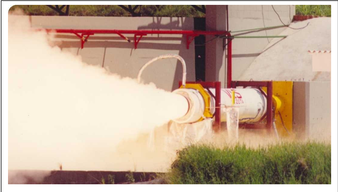
Figura 3. Propulsor utilizado em ensaio de tiro em banco.
