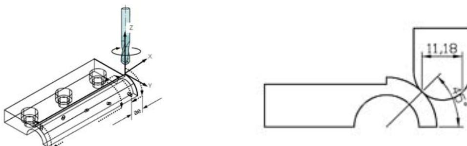
Figura 4. Detalhes da estratégia de corte utilizada: (a) Estratégia de usinagem raster, (b) Ponto de contato entre a ferramenta e a peça para cálculo do diâmetro médio.
