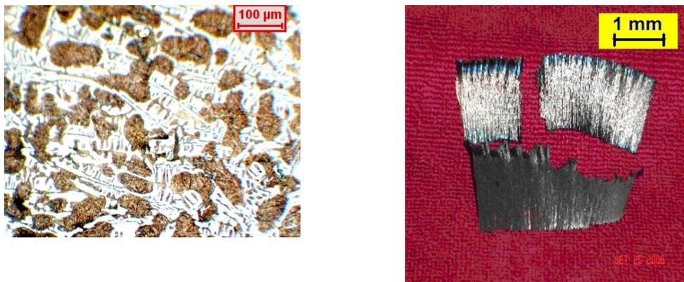
Figura 1. Microestrutura de ferro fundido de coquilhamento definido, e cavacos retirados da mesa de dureza 59 HRC
