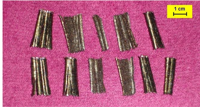
Figura 2. Microestrutura de ferro fundido nodular coquilhado, e cavacos retirados da mesa de dureza 49 HRC
