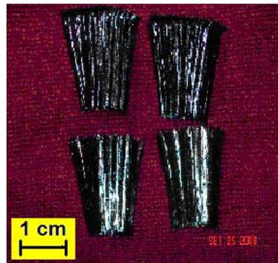
Figura 3. Microestrutura de ferro fundido nodular, e cavacos retirados no desbaste de pescoços de dureza 35 HRC
