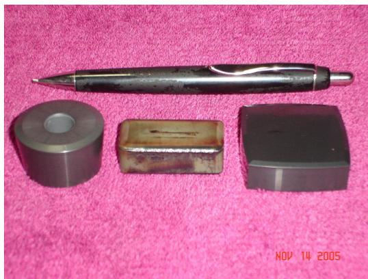
Figura 6. Principais insertos utilizados nos processos de torneamento em cilindros de laminação
